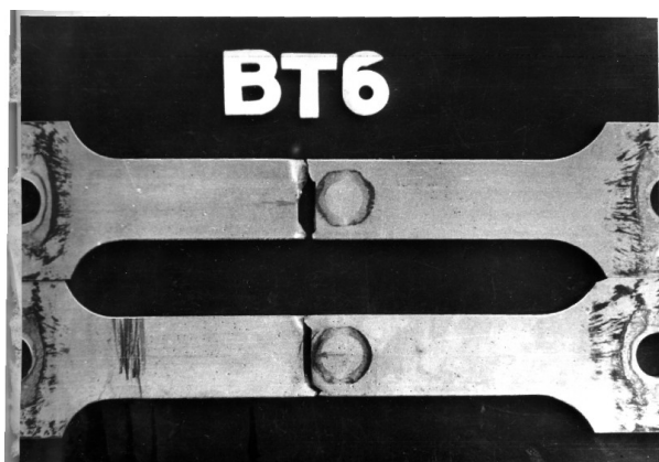
Рис. 7. Характер усталостного разрушения гладкой полосы из сплава VT6 в условиях фреттинг-коррозии при действии контактных давлений различной величины
