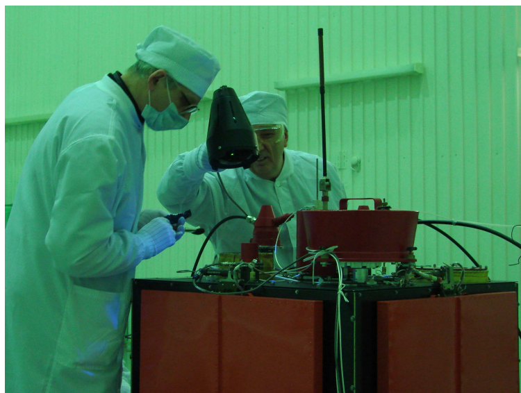
Рис.5. Выполнение визуального контроля чистоты поверхности спутника на соответствие уровню «визуально чистый + ультрафиолет» с помощью ультрафиолетового осветителя
