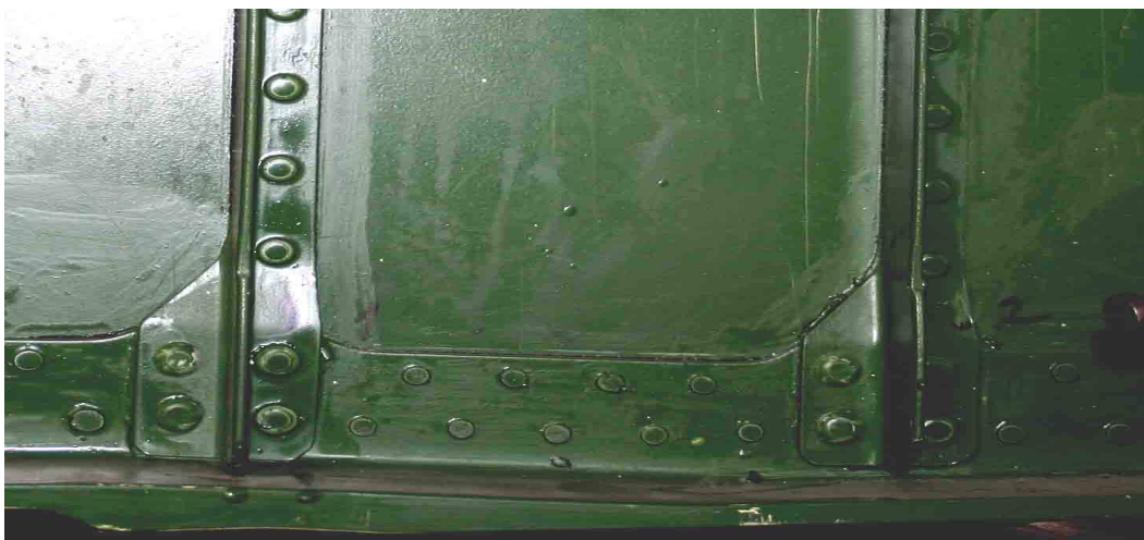
Рис. 14. Соединение пояса лонжерона и стенки с подкрепляющей стойкой
