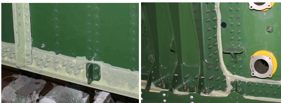
Рис. 15. Соединение поясов лонжерона стенки и подкрепляющих стоек заклепочным и болтовым соединениями
