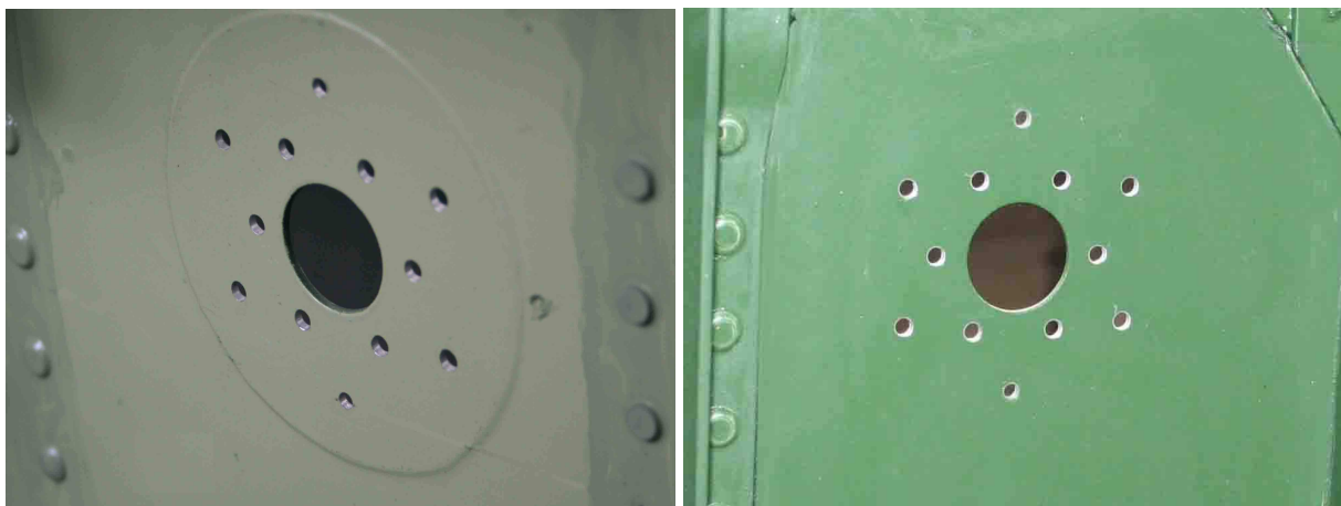
Рис. 12. Конструктивное выполнение выреза с комбинированным усилением
