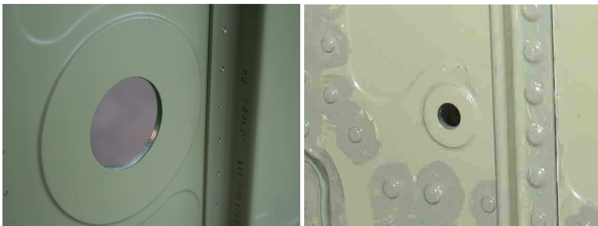
Рис. 11. Конструктивное выполнение монолитных усиления в стенках лонжерона
