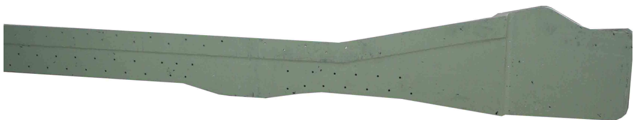
Рис. 4. Характер изменения ширины пояса лонжерона крыла на корневом участке
