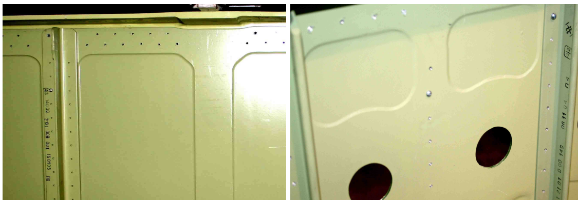
Рис. 13. Галтельные переходы на стенке лонжерона
