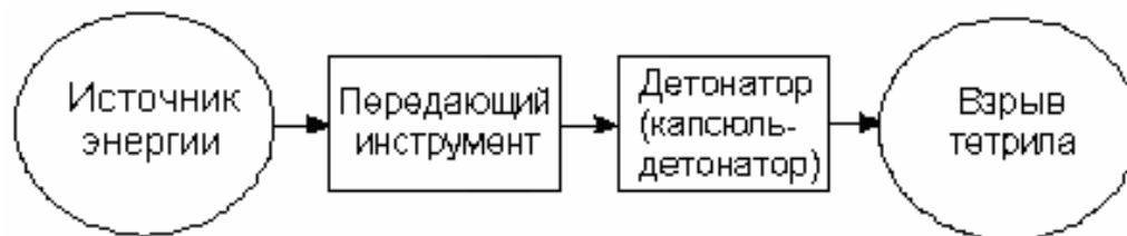
Рис. 6. Схема технологического процесса инициирования взрывателя методом удара
