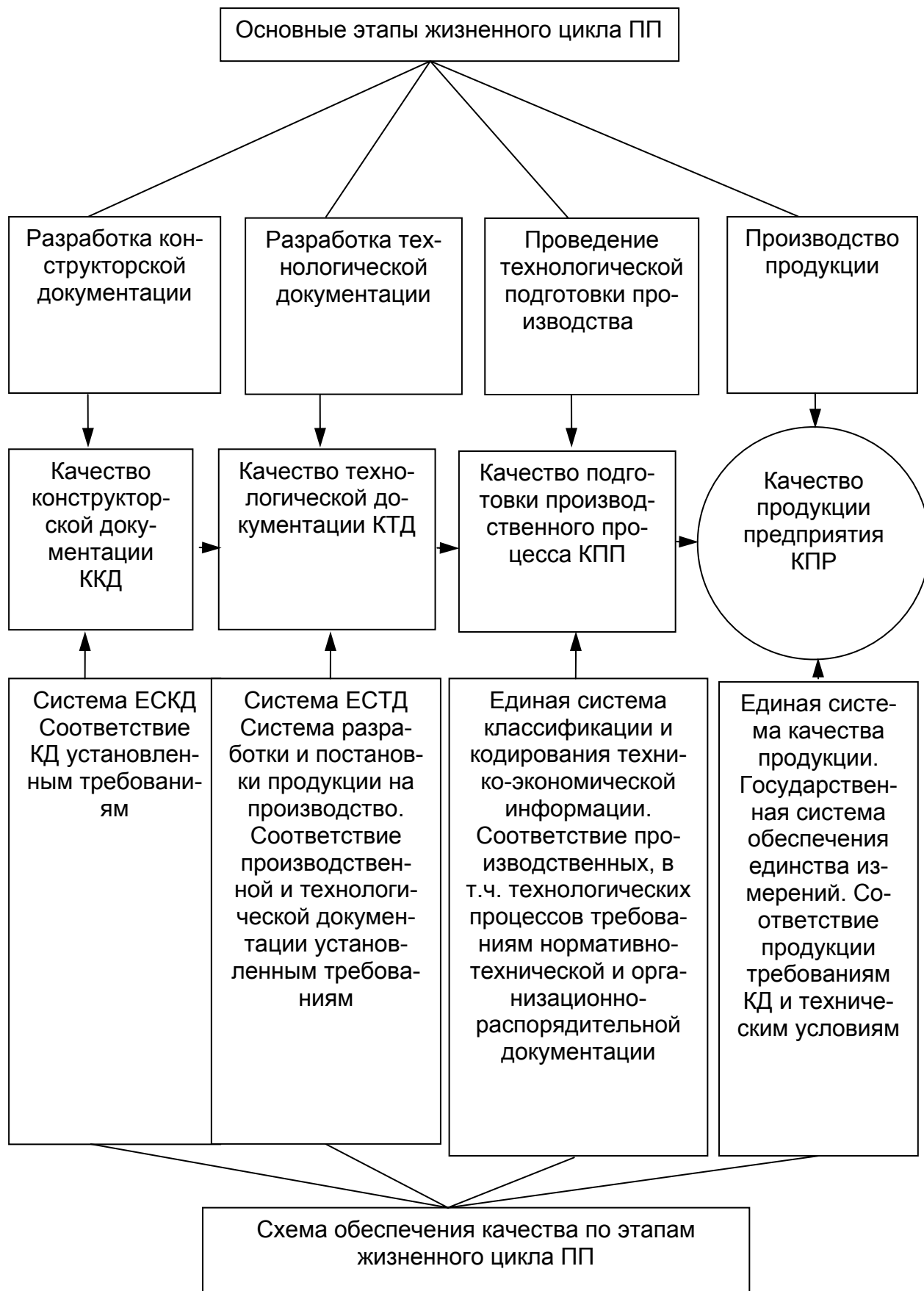
Рис. 1. Модель формирования качества продукции в производственной системе.
