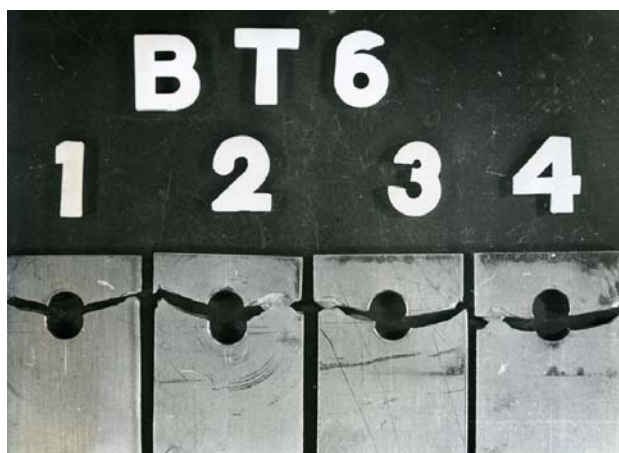
Рис. 5. Характер усталостного разрушения элементов двухсрезовых соединений из титанового сплава ВТ6 при установке болтов: 1, 2 – без радиального натяга и затяжки; 3, 4 – с радиальным натягом и без затяжки
