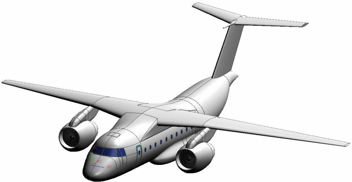
Рис. 13. Мастер-геометрия поверхности гражданского самолета, созданная с помощью компьютерной интегрированной системы CAD/CAM/CAE Unigraphics
